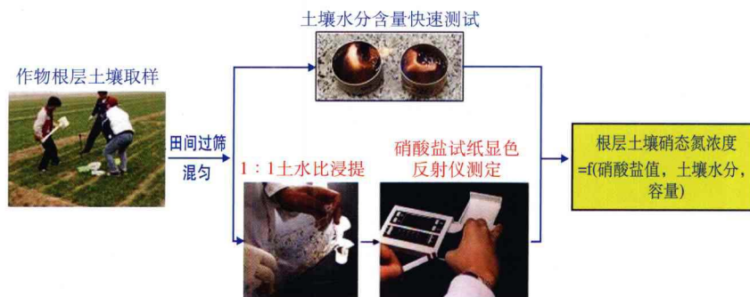
图 2-14 作物根层土壤硝态氮速测技术流程图
