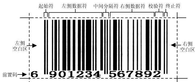
图 11-2 条形码的结构
