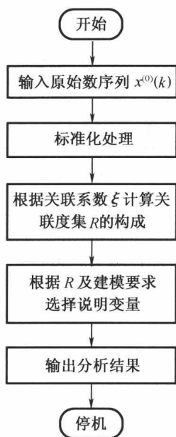
图 2-3 关联度分析的全过程流程图
